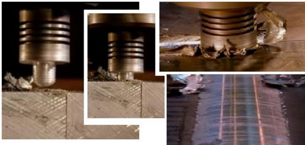
Figura 2.34 – Sequência do processo de FSW e o resultado da solda.
