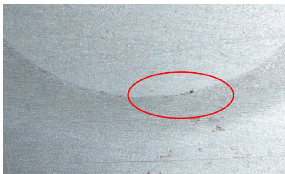
Figura 4.24 – Aparecimento de defeitos na região “A” da soldagem
