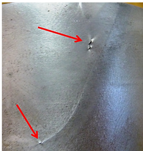
Figura 4.38 - Trincas na amostra G02CP14B soldada com 300 kN.
