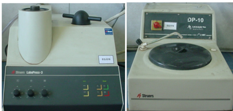
Figura 3.54 - Embutidora LaboPress 3 e politriz modelo DP10.
