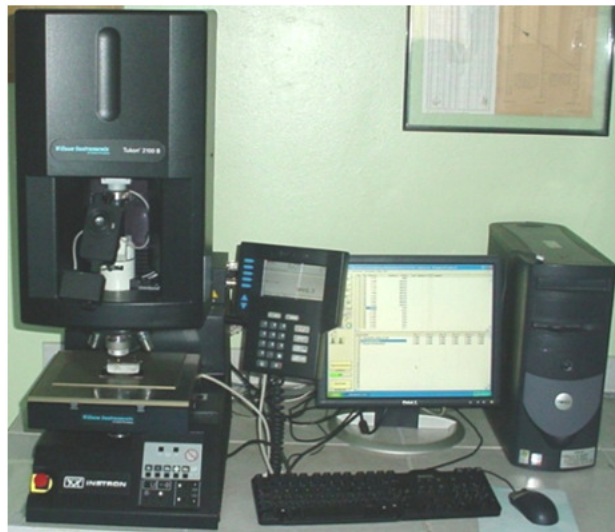
Figura 3.44 – Microdurômetro automático Instron modelo Tukon 2100B .
