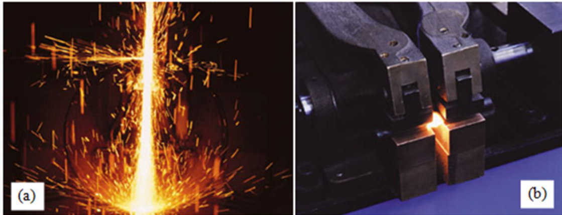
Figura 2.13 - Centelhamento na FW (a), solda sem centelhamento (b) (15) .
