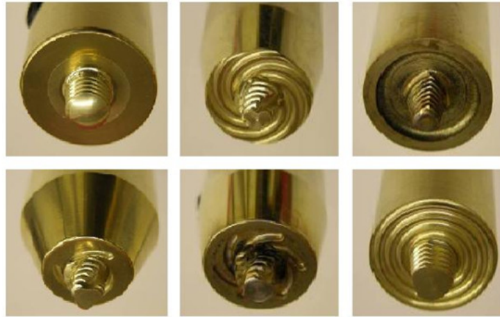
Figura 2.35 – Diferentes geometrias de ferramentas para FSW.
