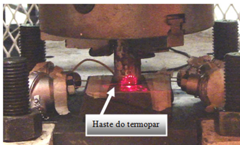
Figura 3.53 – Aquisição da temperatura da rebarba.
