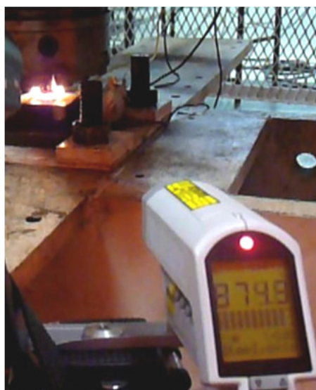
Figura 4.60 - Máxima temperatura na soldagem do G03CP08.
