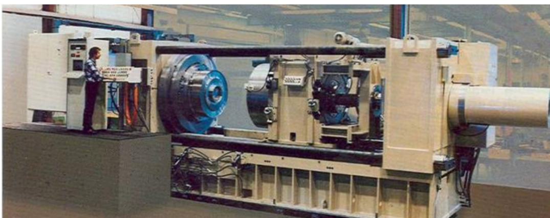
Figura 2.21 – Equipamento para solda a fricção por inércia (23) .
