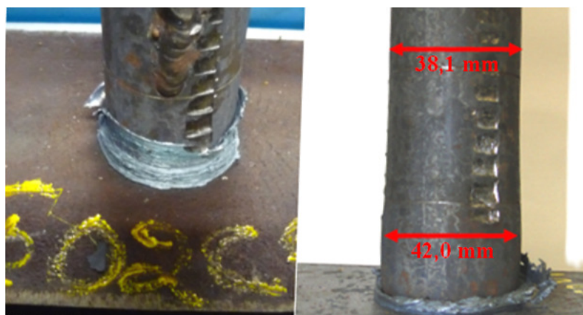
Figura 4.30 – Rebarba e diferença no diâmetro do pino após a soldagem.
