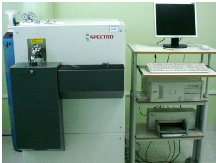
Figura 3.35. - Espectrômetro óptico Spectrolab .
