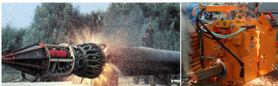
Figura 2.15 – Aplicações de Flash Welding para união de tubos (19)(20) .
