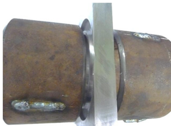
Figura 4.81 – Usinagem do anel para a soldagem tubo-anel-tubo.
