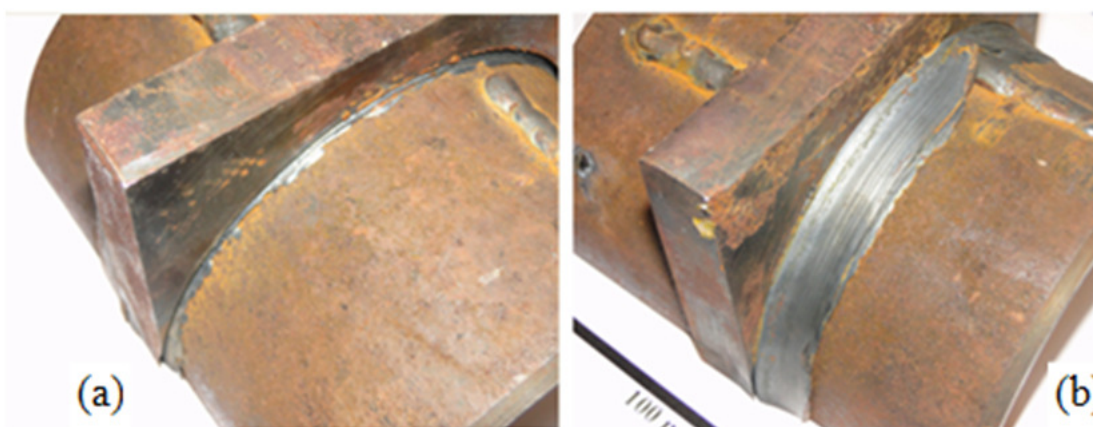
Figura 4.85 – Rebarba para soldas com 2 mm em (a) e com 5 mm em (b).
