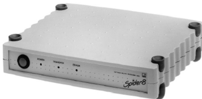
Figura 3.49 – Amplificador e conversor A/D Spider 8 da HBM (46) .
