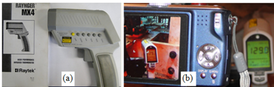
Figura 3.52 – Pirômetro em (a) e a filmagem do visor do pirômetro em (b).
