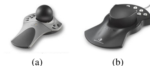
Figura 3.19: Dispositivos de entrada 3D: (a) Spaceball e (b) Spacemouse
