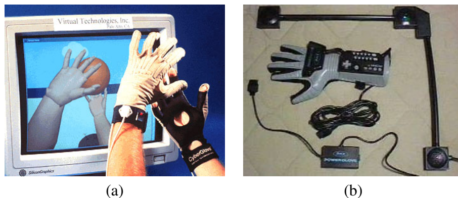
Figura 3.22: Dispositivos para reconhecimento de gestos: (a) CyberGlove da Virtual Technologies e (b) PowerGlove da Mattel
