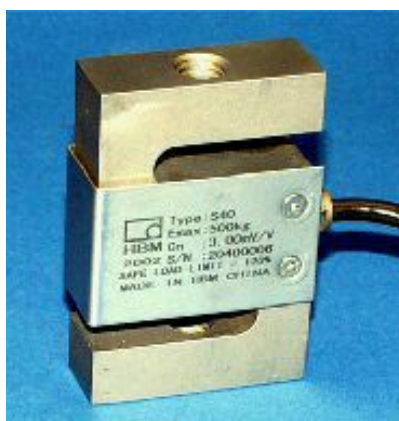
Figura 3-9: Célula de carga utilizada nos ensaios de corrosão-fadiga.
