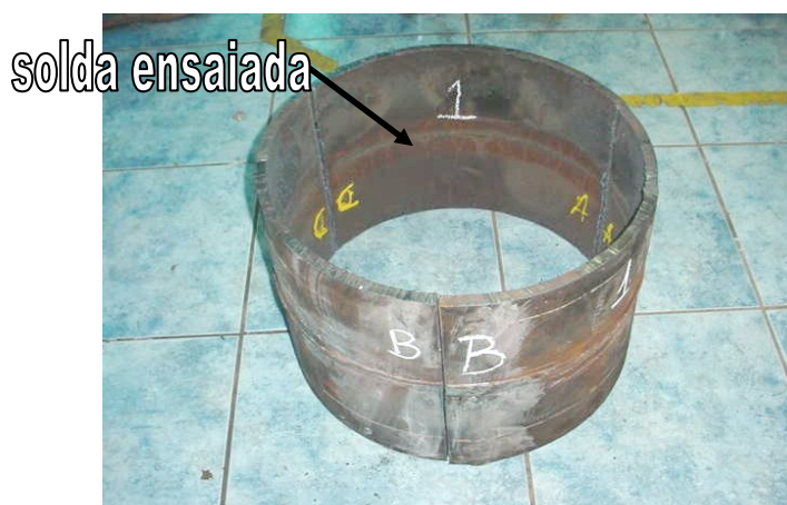
Figura 3-18: Tubo soldado recebido para retirada dos corpos de prova.
