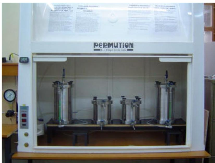
Figura 3.6 – Vista geral dos permeômetros instalados em uma capela de exaustão de gases
