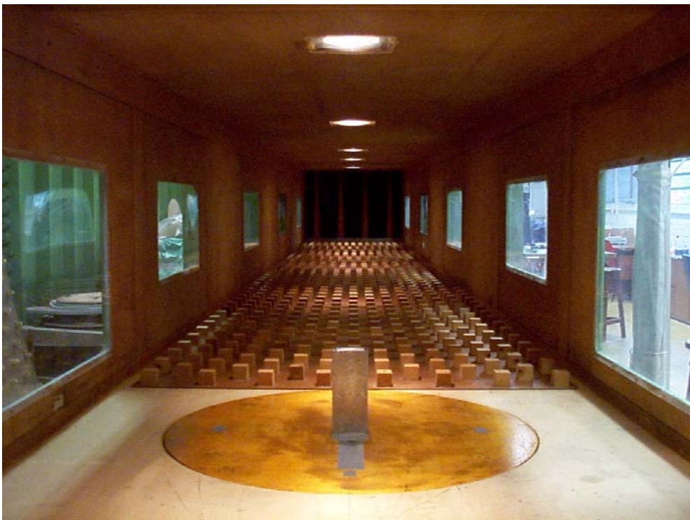
Figura 3.7 – Modelo monitorado revestido com alumínio, isolado, no interior do túnel de vento, com simuladores da rugosidade.
