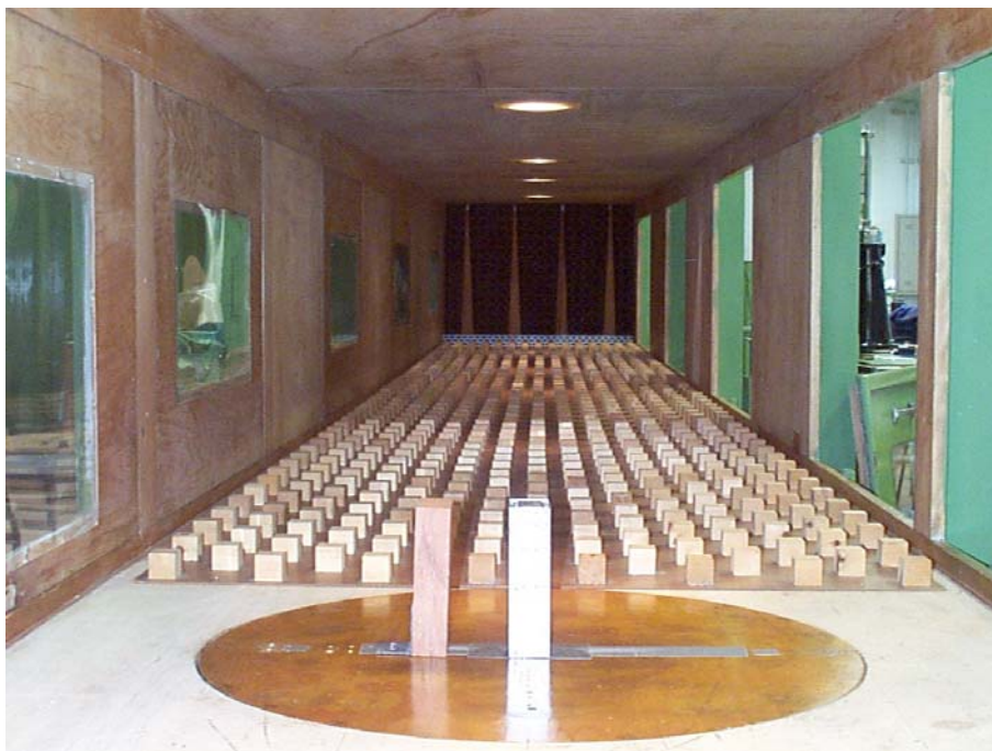
Figura 3.5 – Modelo mudo e modelo monitorado revestido com alumínio no interior do túnel de vento, com simuladores da rugosidade.
