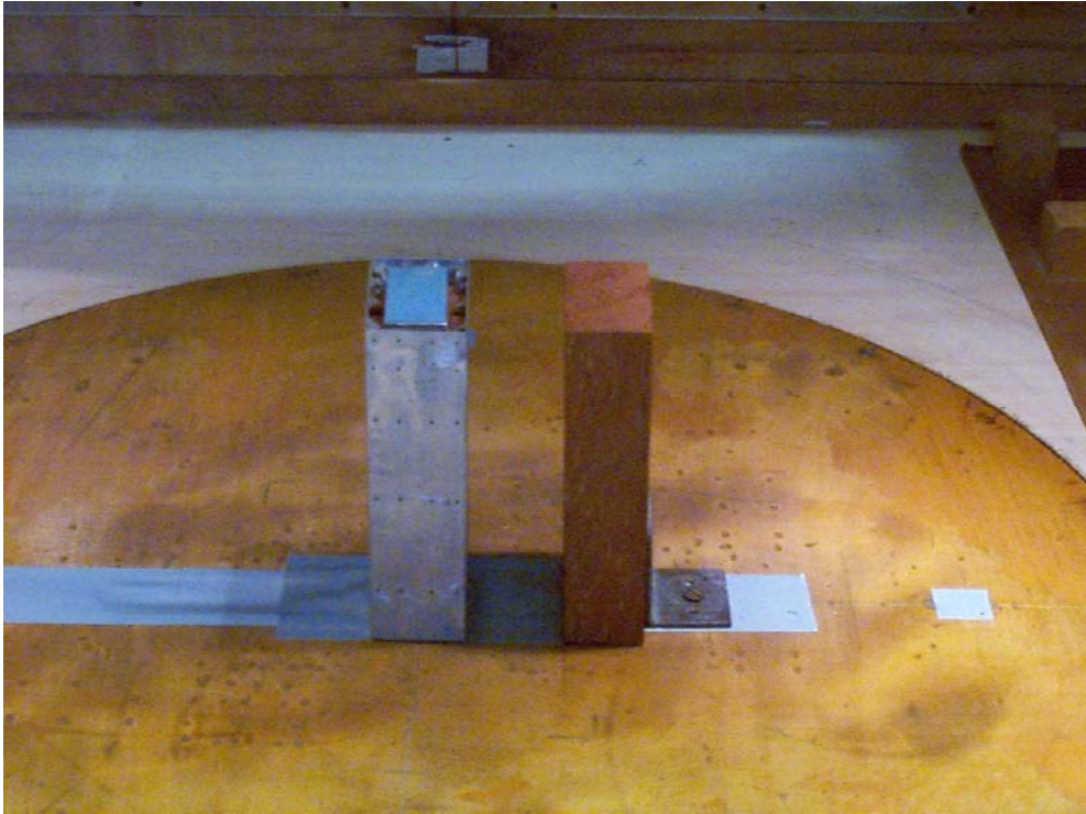
Figura 3.6 – Modelo mudo e modelo monitorado revestido com alumínio no interior do túnel de vento, utilizado para simular o modelo com vizinhança 1b com p=0,34 .
