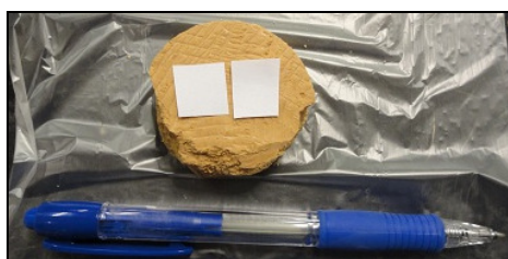
Figura 3.3 – Corpo-de-prova de caulim-cal para o ensaio de sucção matricial
