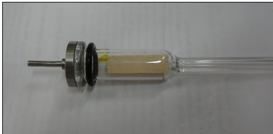
Figura 3.14 – Amostra de caulim-cal dentro do tubo capilar provido de um porta amostra para a realização do ensaio de PIM
