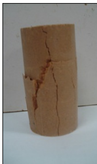
Figura 4.57a – Corpo-de-prova de caulim-cal submetido ao ensaio de resistência à compressão simples (LEGG/ENVIRONGEO – UFRGS)
