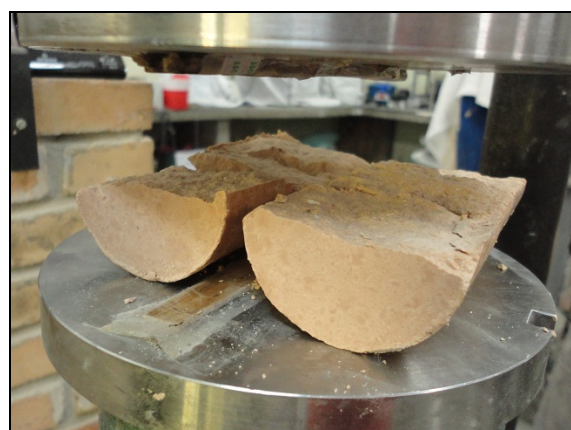
Figura 4.85b – Corpo-de-prova de caulim-cal submetido ao ensaio de resistência à tração
