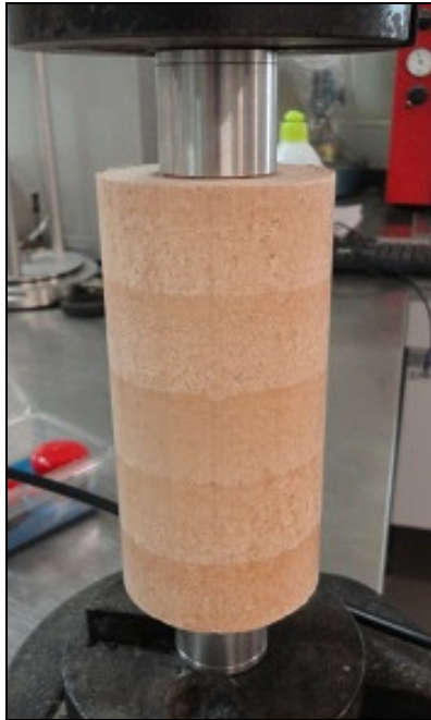
Figura 3.6 – Corpo-de-prova de caulim-cal submetido ao ensaio de medidas de rigidez inicial
