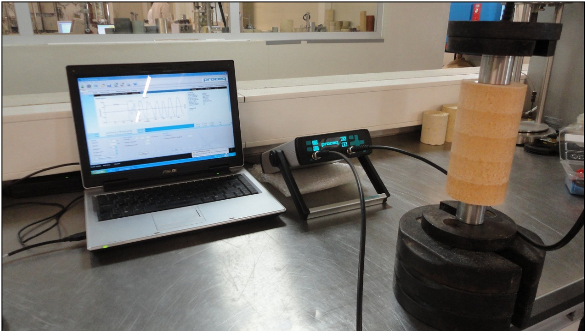
Figura 3.7 – Equipamento Ultrassônico Pundit Lab sendo utilizado no ensaio de medidas de Rigidez Inicial de uma amostra de caulim-cal
