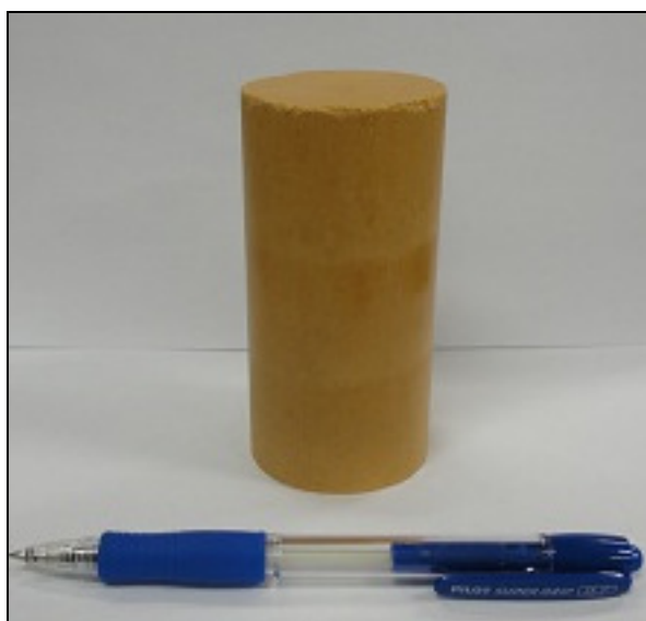
Figura 3.1 – Corpo-de-prova de caulim-cal para o ensaio de resistência à compressão simples
