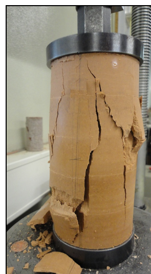
Figura 4.57b – Corpo-de-prova de caulim-cal submetido ao ensaio de resistência à compressão simples (LABGEO – FEUP)
