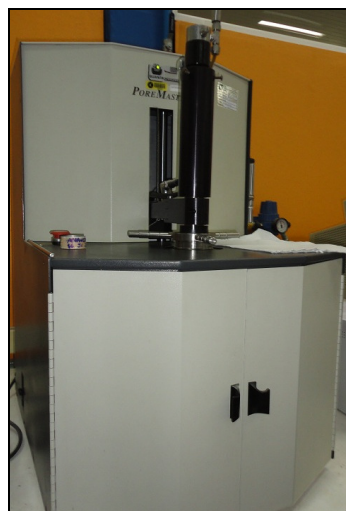
Figura 3.15 – Porosímetro por intrusão de mercúrio do Laboratório de Materiais de Construção da UNISINOS
