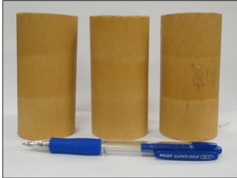
Figura 3.4 – Corpos-de-prova de caulim-cal para o ensaio de resistência à tração
