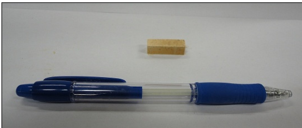
Figura 3.12 – Aspecto final de um corpo-de-prova para o ensaio de porosímetro por intrusão de mercúrio
