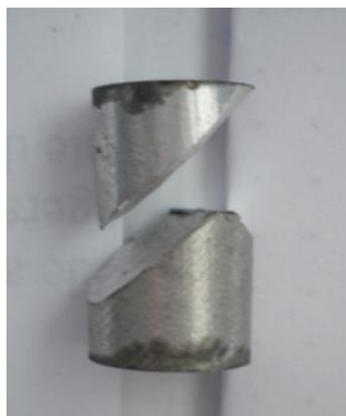
Figura 34 - Amostras submetidas ao ensaio de compressão.
