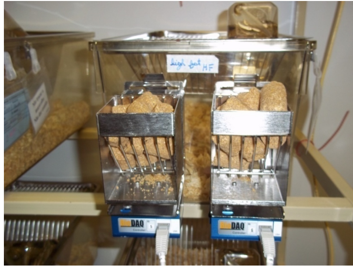
Figura 5: Vista do BioDAQ®. Balanças e comedouros conectados à caixa moradia.
