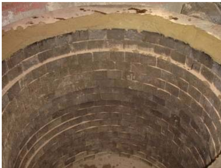
Figura 3.7 – Ilustração da Massa utilizada para Acabamento da Panela Fonte Gerdau Riograndense, 2009.
