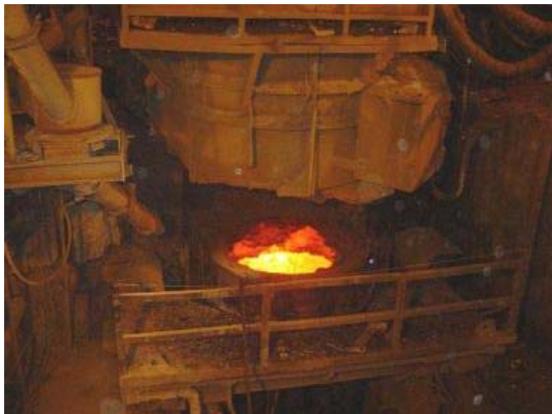
Figura 3.8 – Panela no Trole Aguardando Início de Vazamento Fonte Gerdau Riograndense, 2009.
