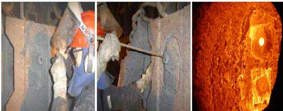
Figura 3.12 – Panela no Trole de Aquecimento para as suas Devidas Inspeções Fonte Gerdau Riograndense, 2009.
