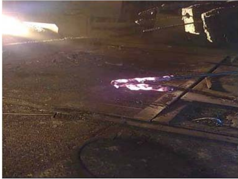
Figura 3.15 – Escória na vara metálica em formato L após coleta pela porta do FEA Fonte Gerdau Riograndense, 2009.
