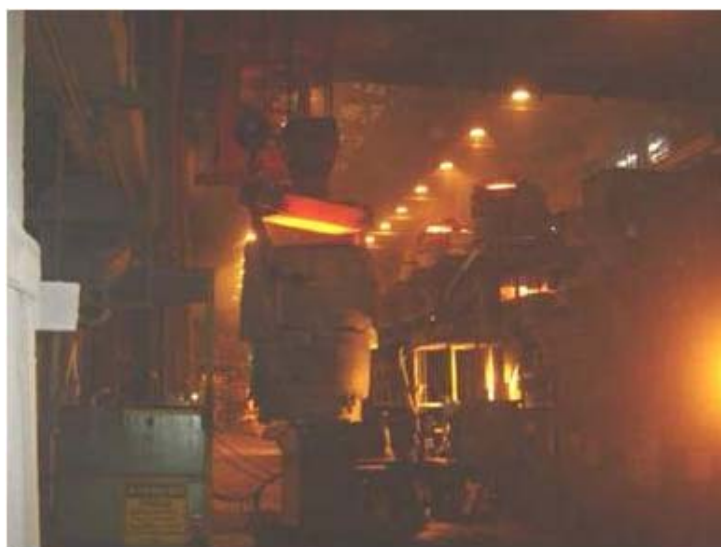
Figura 3.11 – Panela Sendo Transportada para Trole de Aquecimento Fonte Gerdau Riograndense, 2009.
