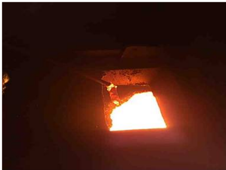
Figura 3.16 – Escória na vara metálica em formato L após coleta pela abertura na abóboda do FP Fonte Gerdau Riograndense, 2009.
