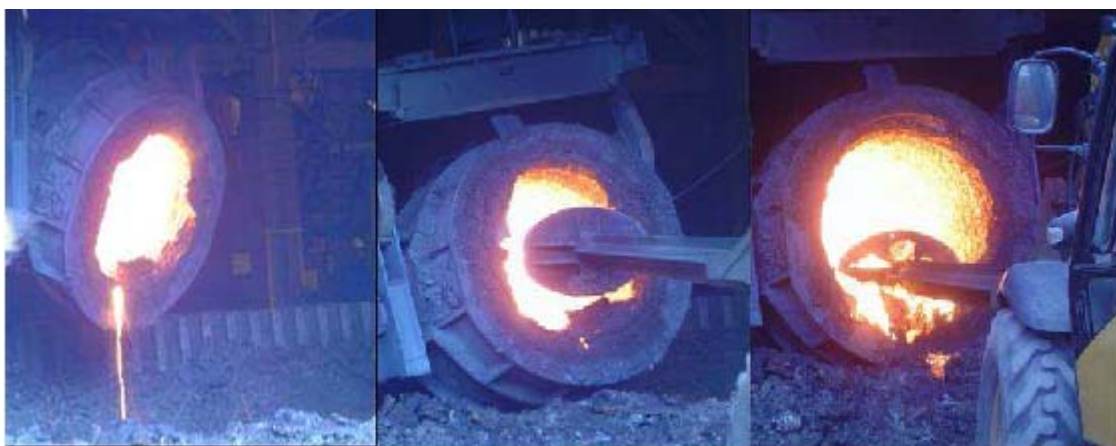
Figura 3.10 – Panela Durante Etapa de Limpeza na Baia de Escória Fonte Gerdau Riograndense, 2009.
