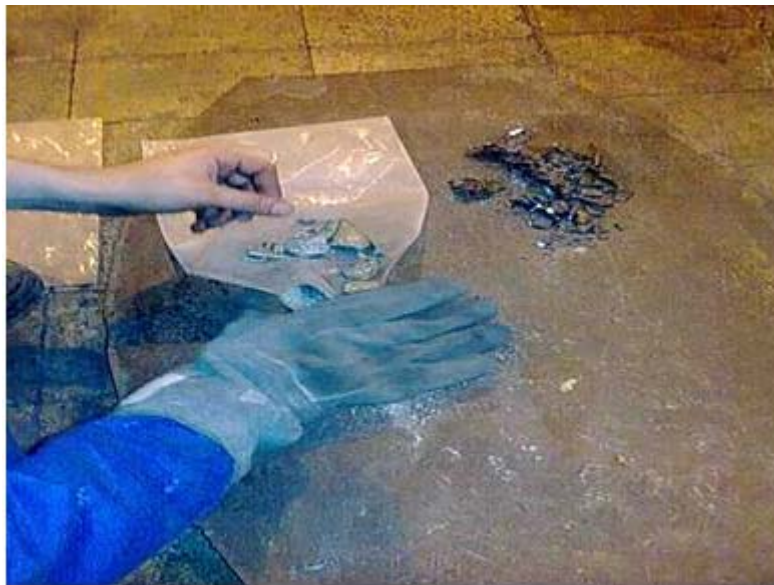
Figura 3.17 – Escórias na chegada e saída do FP sendo coletadas para análise química
