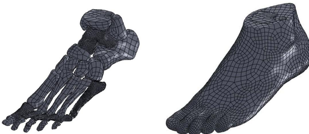
Figura 3.5 - Superfície suavizada dos ossos e externa para instante de tempo do toque do calcanhar
