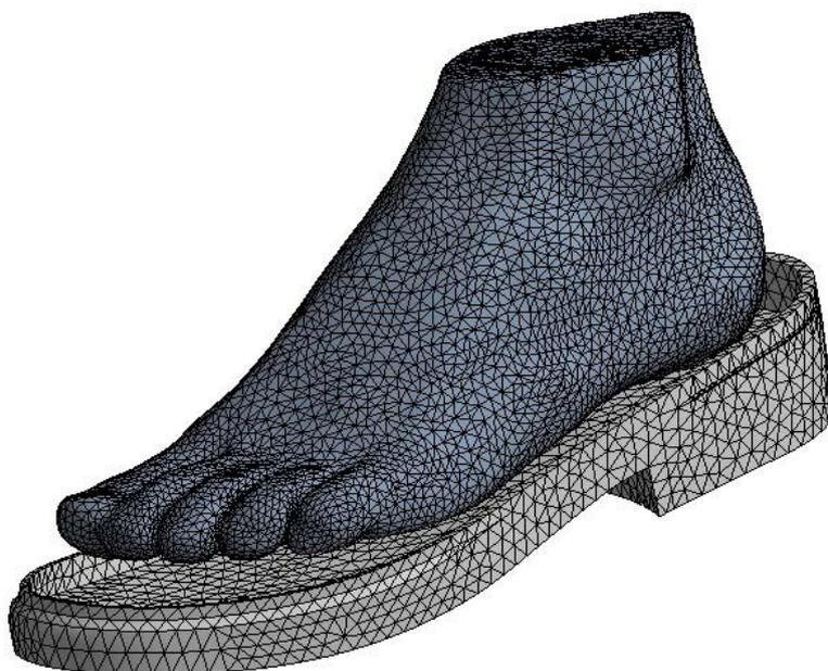
Figura 3.12 – Malha de elementos finitos gerada no modelo para o instante de tempo após o toque do calcanhar - Instante 1.
