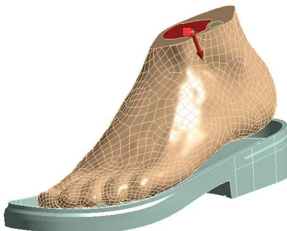
Figura 5.8 - Força aplicada no modelo de elementos finitos para segundo instante de tempo.
