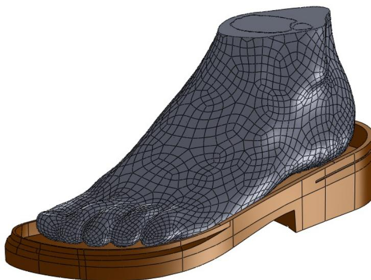
Figura 3.10 – Conjunto de geometrias usado para geração da malha de elementos finitos no instante após o toque do calcanhar.
