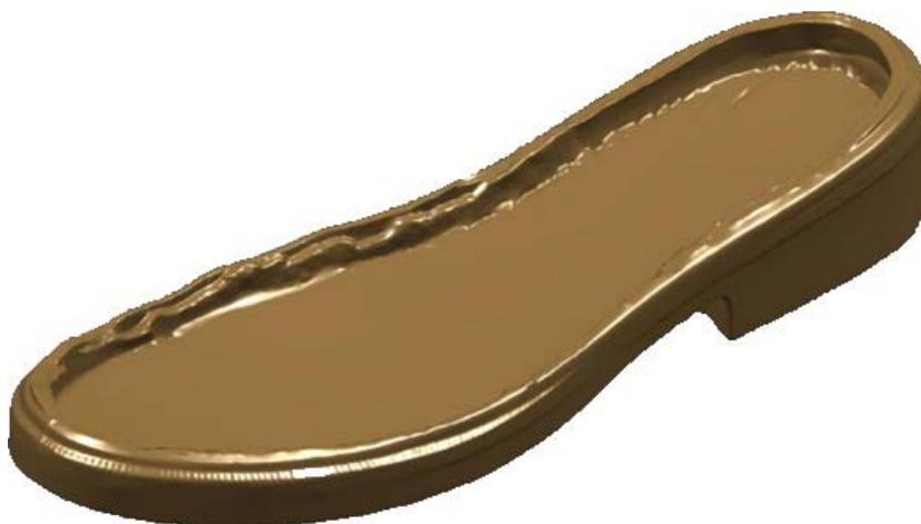
Figura 3.8 – Sólido formado pela nuvem de pontos fornecida pelo scanner 3D
