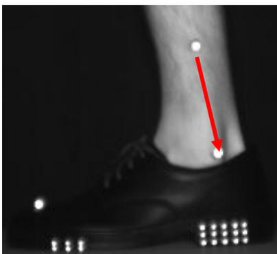
Figura 5.7 - Eixo usado para aplicar força e restrições.
