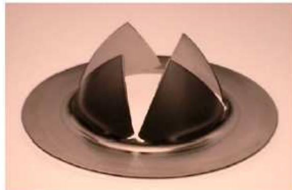
Figura 2.25. Disco de ruptura antes e depois da ruptura.
