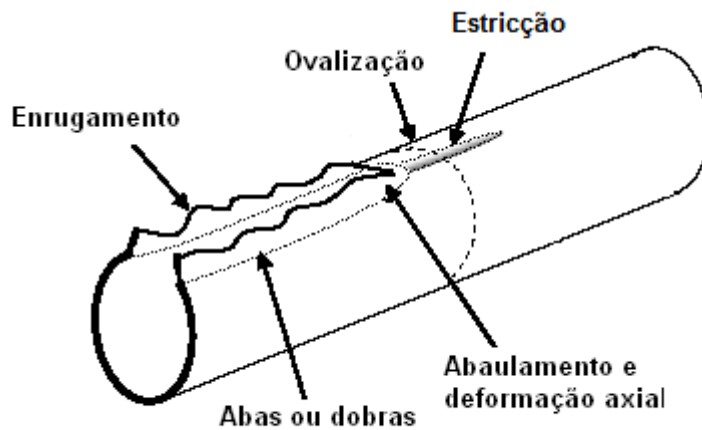
Figura 2.5. Características típicas de fraturas dúcteis propagantes em dutos. (SCHINDLER 2010)
