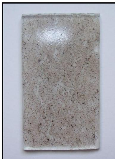
Figura 4.6: Lamina delgada utilizada para microfotografias.
