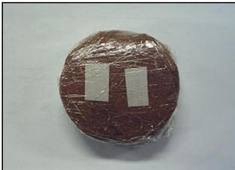
Figura 3.21: corpo-de-prova para ensaio de sucção matricial.
