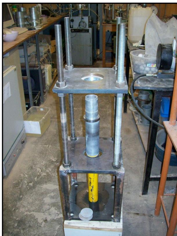
Figura 3.12: Equipamento para desmoldar corpos-de-prova.
