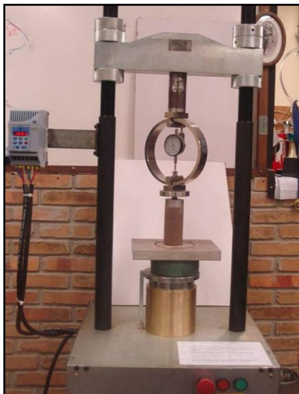
Figura 3.13: Prensa automática para rompimento dos corpos-de-prova.
