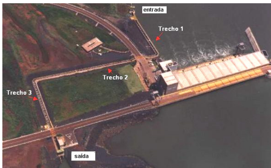
Figura 4.1. Vista aérea da escada para peixes da UHE Igarapava. Fonte: Magalhães (2004).
