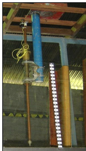
Figura 4.17. Foto da ponta linimétrica usada no experimento.
