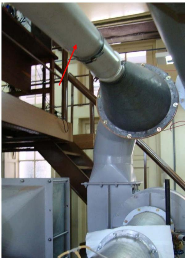
**Figura 5. 4:** Detalhe do duto extensor colocado após o ventilador para as medidas de velocidade.
