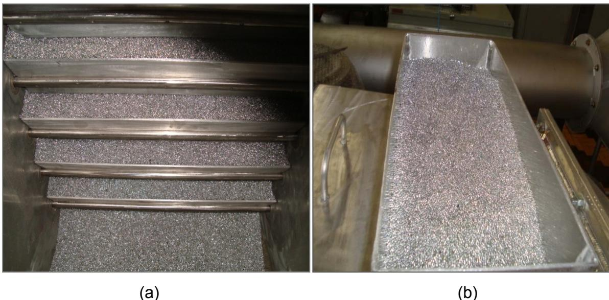
**Figura 5. 2:** Leito completo com as esferas de vidro (a); preenchimento completo até o bocal de alimentação (b).
