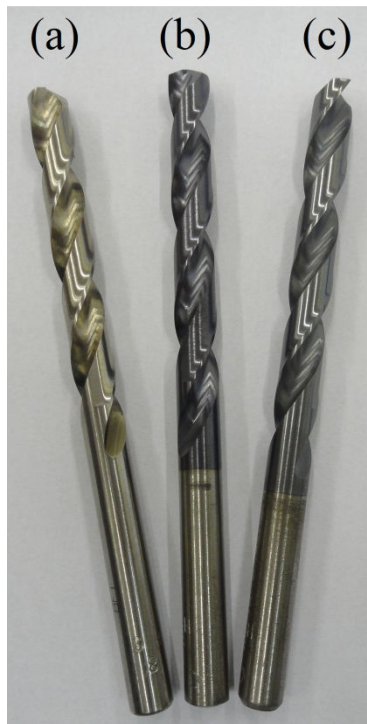
Figura 3.8 Brocas para início dos testes de usinagem, (a) sem revestimento, (b) com revestimento do composto TiAlN e (c) com revestimento do composto AlCrN
