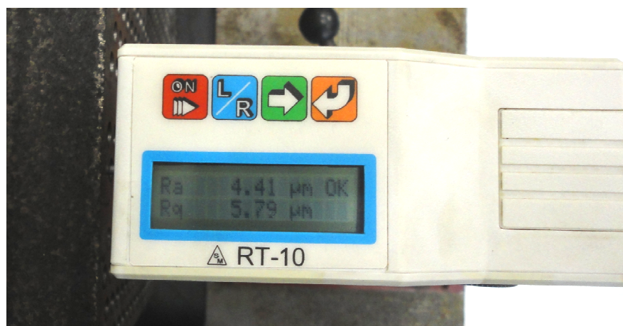
Figura 3.13 Rugosímetro realizando medição em furo de uma das placas de ferro fundido nodular
