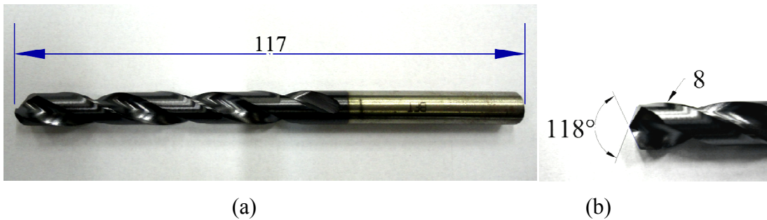
Figura 3.7 Broca helicoidal conforme DIN 338 (a) comprimento total e (b) detalhe do ângulo de ponta
