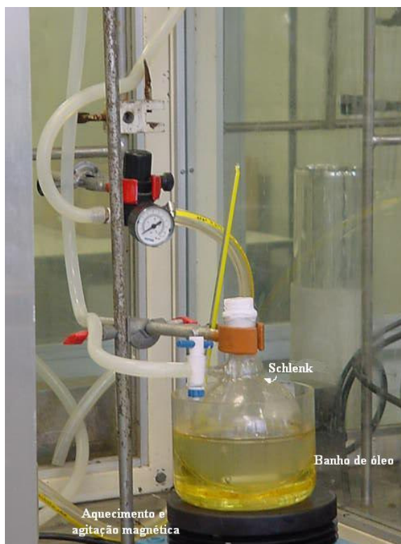
Figura 15: Reator de vidro utilizado para polimerização com o catalisador.
