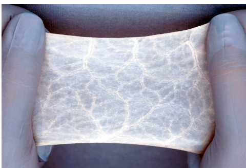
Figura 5: Membrana de PLLA.
