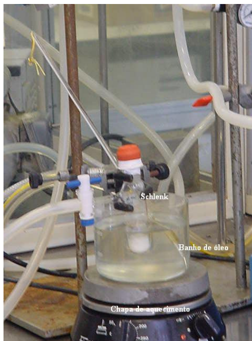
Figura 16: Reator de vidro utilizado para o aumento de massa molar.
