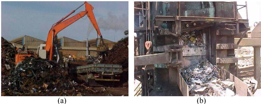
Figura 28 - Pátio de Sucata da Gerdau AEP: (a) Retirada da sucata dos caminhões. (b) Guilhotina da prensa tesoura.
