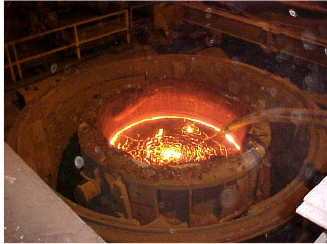
Figura 33 - Operação de injeção de fios na panela.
