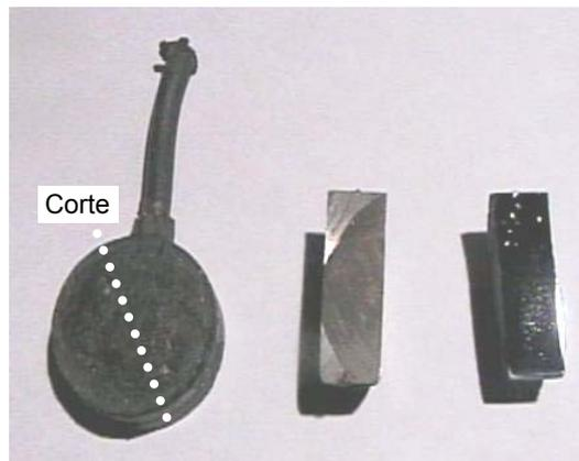
Figura 42 - Sequência de preparação dos corpos de prova para análise.
