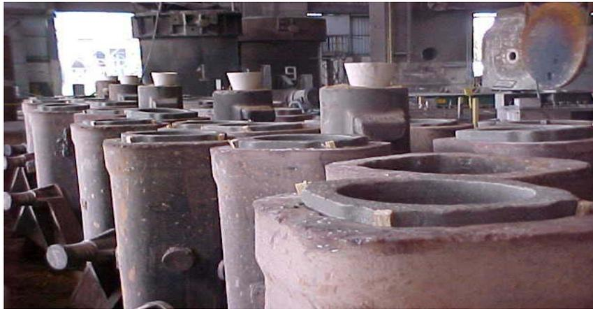
Figura 36 - Lingotamento convencional da Gerdau AEP.
