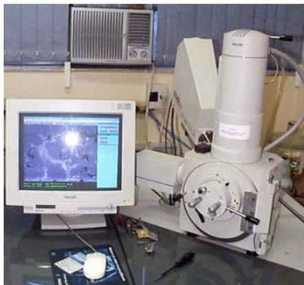
Figura 43 - Microscópio Eletrônico de Varredura com EDS acoplado.
