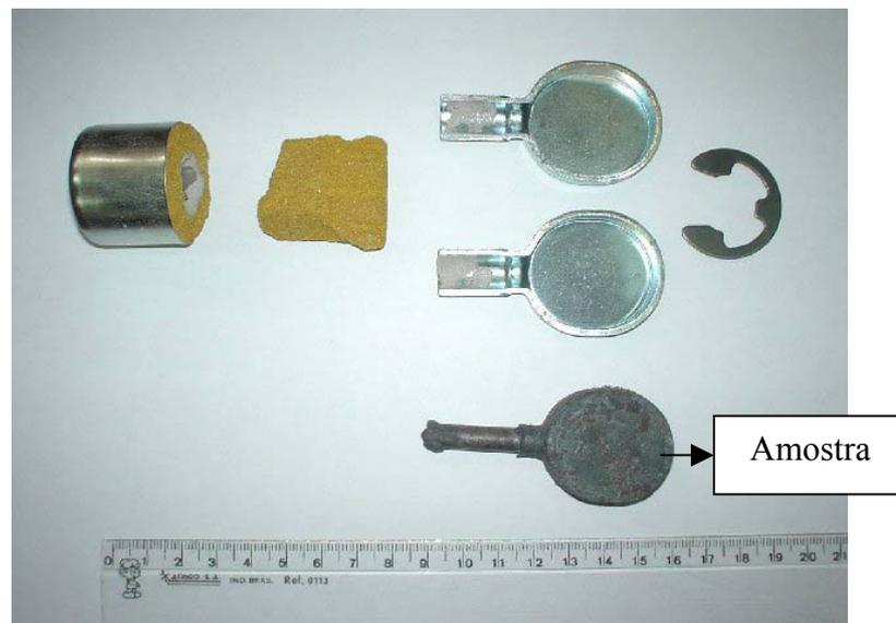
Figura 40 - Partes que compõem o amostrador utilizado no FP (tipo (b)).
