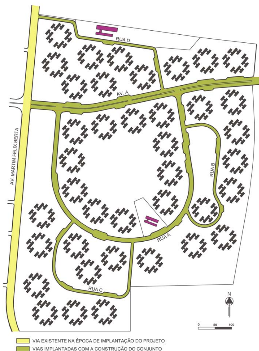
FIGURA 39 – Sistema de circulação existente e implantado. Fonte: Companhia de Habitação do Estado do Rio Grande do Sul – COHAB/RS. Desenho deste autor, 2005.
