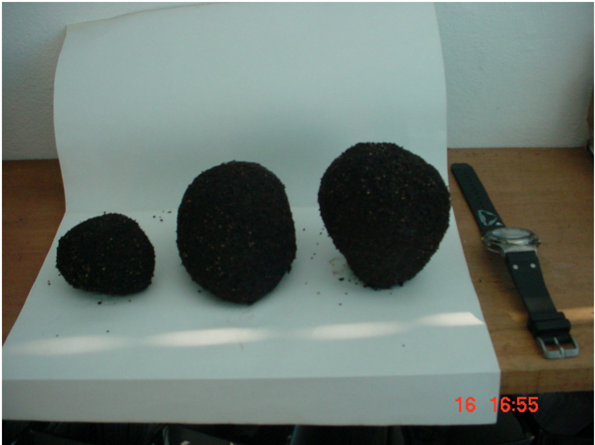
Figura 5.1. Parte do leito filtrante colmatado no tratamento com Veta organic .
