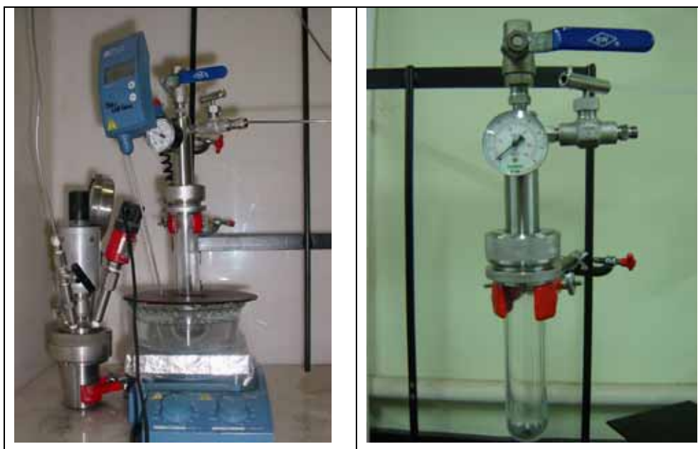
Figura 31. Sistema reacional (esquerda) e reator Fischer-Porter (direita) utilizados na síntese de nanopartículas e em reações de hidrogenação catalítica.
