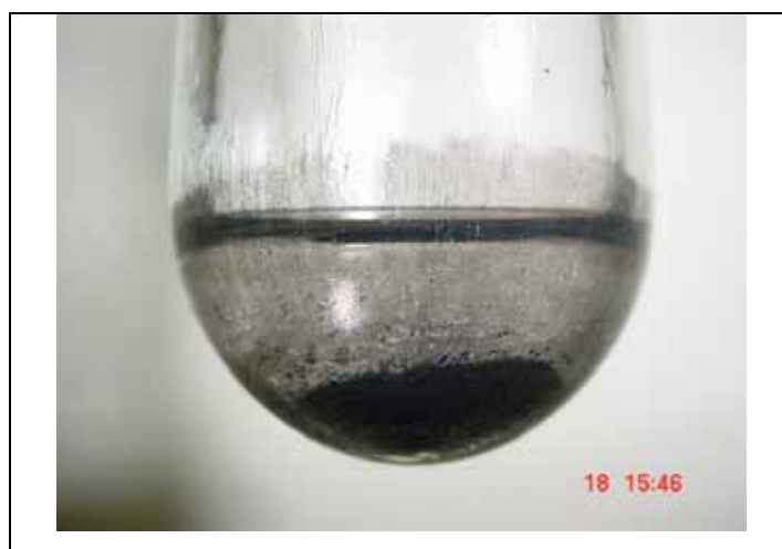
Figura 33. Síntese de nanopartículas de Pt (0) em meio sem solvente. No final da reação de hidrogenação pode-se observar a aglomeração metálica.
