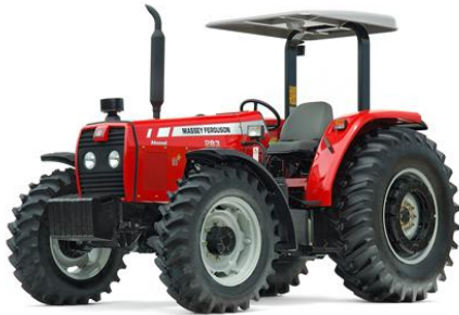
Figura 1: Trator Massey Ferguson plataforma com ROPS de dois postes. (fonte: AGCO do Brasil)
