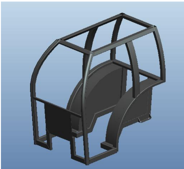
Figura 14: Estrutura da cabina para trator estreito sem o assoalho. (fonte: autor)
