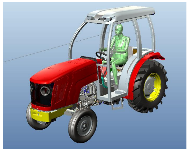
Figura 12: Imagem em perspectiva do lay-out do trator estreito com a cabina e o teto já montados. (fonte: autor).
