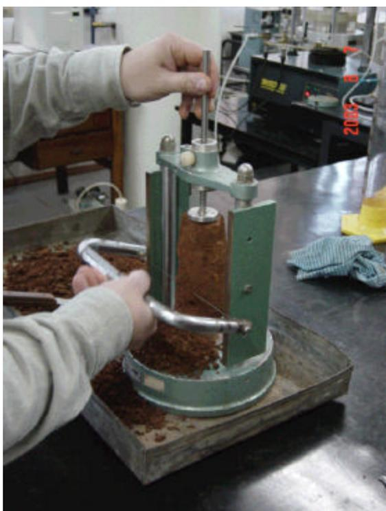
**Foto 4.16** – Moldagem do corpo de prova para ensaios triaxiais
