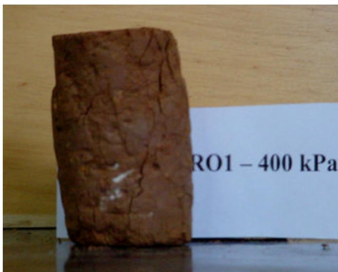
**Foto 5.3** – Deformação pós-pico do corpo de prova ensaiado com tensão confinante efetiva de 400 kPa, referente ao km 1000 (Bloco RO1)
