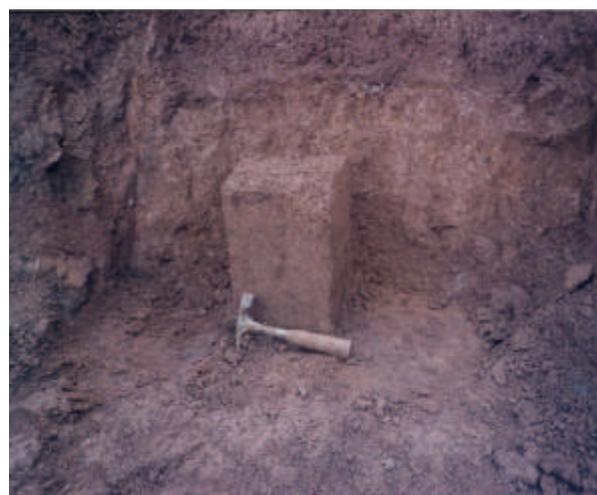
**Foto 4.5** – Bloco RO1, moldado em solo coluvionar, amostrado do km 1000
