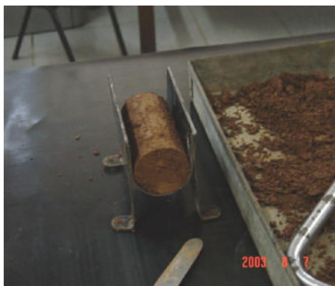
**Foto 4.17** – Regularização do topo e da base do corpo de prova moldado para ensaios triaxiais.
