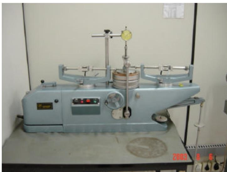
**Foto 4.10** – Equipamento *ring shear* de amostras deformadas, do tipo deformação controlada, da marca *Wikeham Farrance Int.*
