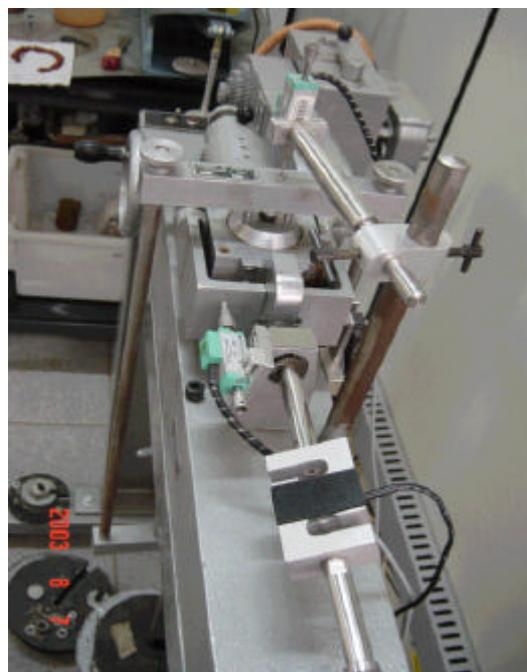
**Foto 4.9** – Detalhe do equipamento para ensaio de cisalhamento direto instrumentado
