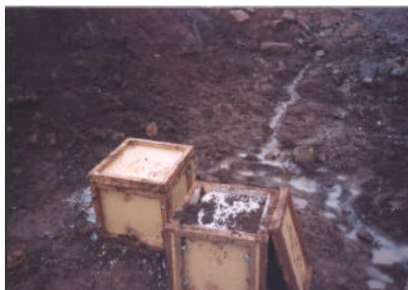
**Foto 4.7** – Detalhe do bloco R01, com a base regularizada e parafinada, pronto para o transporte
