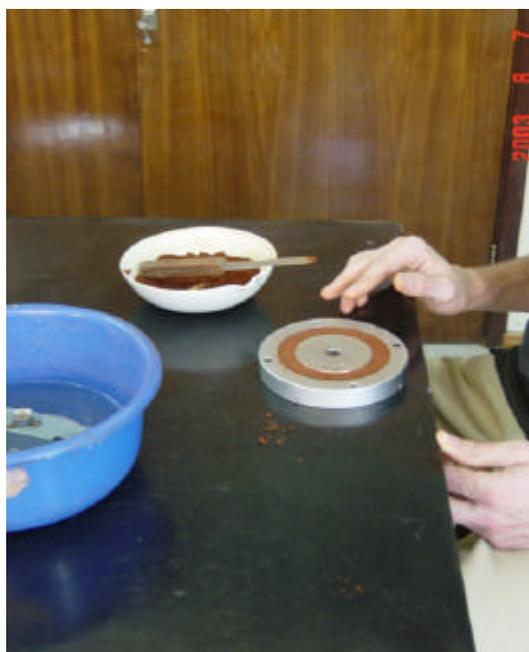
**Foto 4.11** – Processo de moldagem do corpo de prova para ensaio *ring shear*
