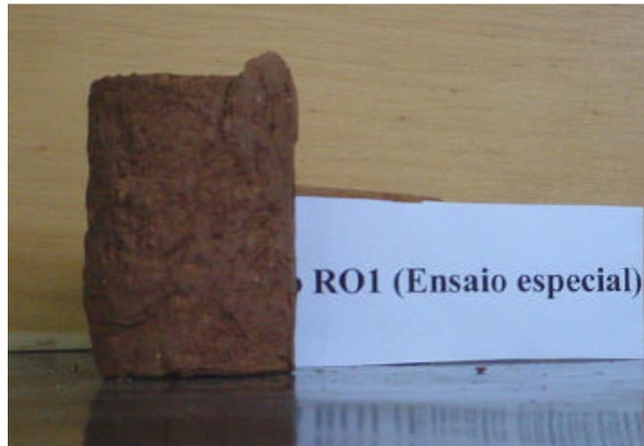
**Foto 5.4** – Deformação pós-pico do corpo de prova ensaiado com tensão confinante efetiva de 20 kPa, referente ao km 1000 (Bloco RO1)
