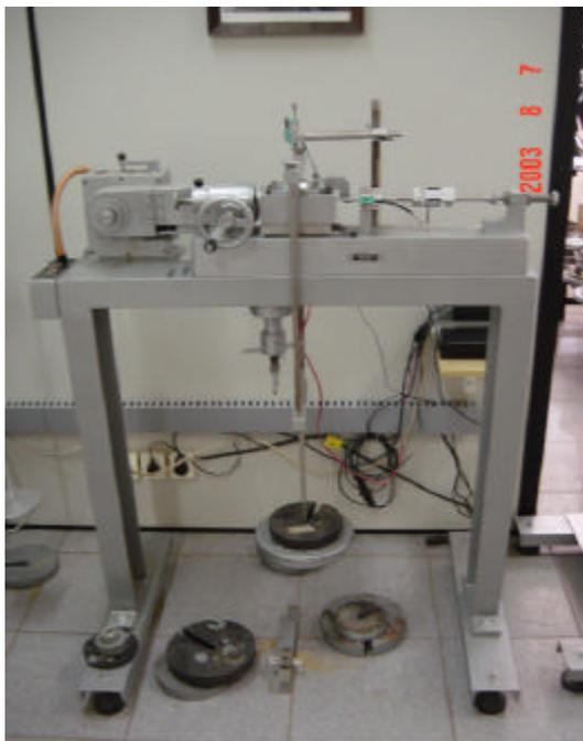
**Foto 4.8** – Equipamento para ensaio de cisalhamento direto instrumentado
