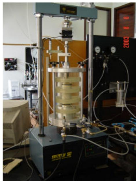
**Foto 4.13** – Equipamento para ensaio triaxial instrumentado
