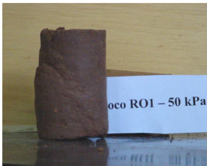
**Foto 5.1** – Deformação pós-pico do corpo de prova ensaiado com tensão confinante efetiva de 50 kPa, referente ao km 1000 (Bloco RO1)
