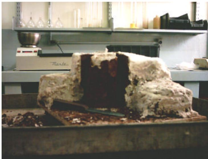
**Foto 4.15** – Detalhes da amostra para posterior moldagem do corpo de prova para ensaios triaxiais
