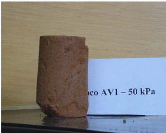
**Foto 5.2** – Deformação pós-pico do corpo de prova ensaiado com tensão confinante efetiva de 50 kPa referente ao km 998 (Bloco AV1)
