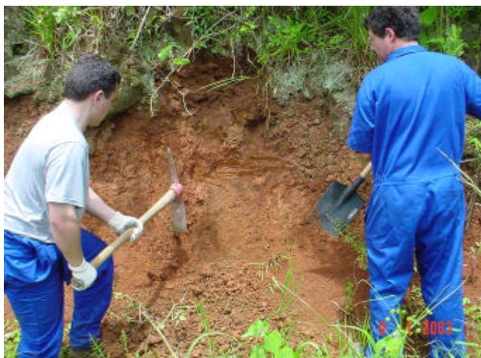
**Foto 4.3** – Preparação da bancada para moldagem dos blocos ES1 e ES2, no km 998
