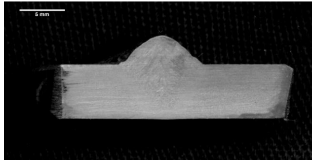
Figura 4.2: Cordão de solda sem discontinuidades aparentes CP10.
