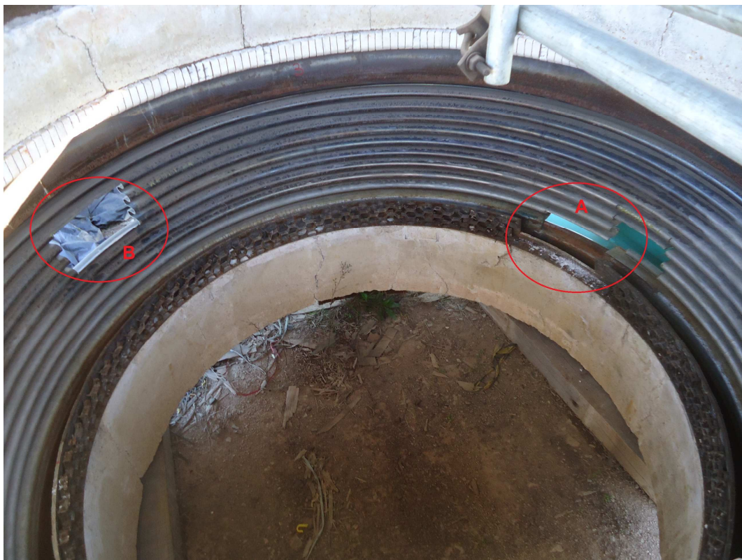
Figura 15 – Recortes realizados na SXB-300003 para avaliação e remoção de material para análises.
