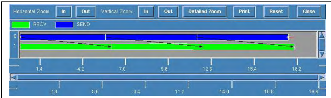
Figura 5.13: Visualização de uma aplicação MPI utilizando a ferramenta Upshot, que acompanha a distribuição da implementação MPICH
