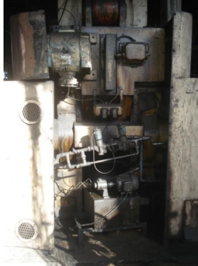
Fig. 6 – Acesso à parte traseira da prensa sem sistema de proteção. (Fonte empresa “X”)
