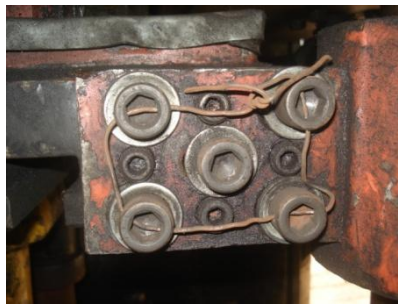
Fig. 17 – Parafusos da mesa do martelo fixos de forma provisória. (Fonte empresa “X”)
