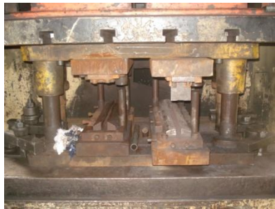
Fig. 9 – Fixação das ferramentas através de grampos de aço. (Fonte empresa “X”)
