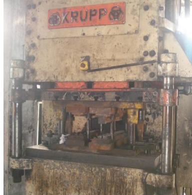
Fig. 4 – Localização do botão de emergência. (Fonte empresa “X”)
