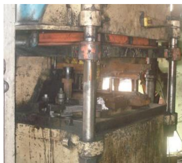
Fig. 3 – Zona de Prensagem sem sistemas de segurança. (Fonte empresa “X”)
