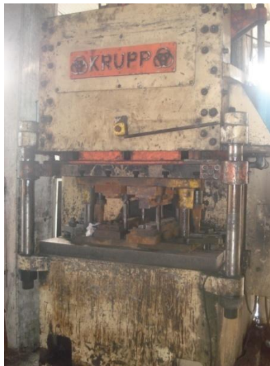
Fig. 2 – Prensa mecânica excêntrica servoacionada por comando pneumático. (Fonte empresa “X”)
