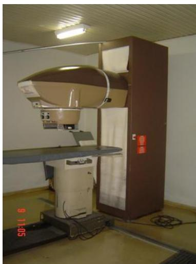
Figura 10: Irradiador de raios gama de  $^{60}\text{Co}$  do Laboratório de Radiação Ionizante do IEAv.
