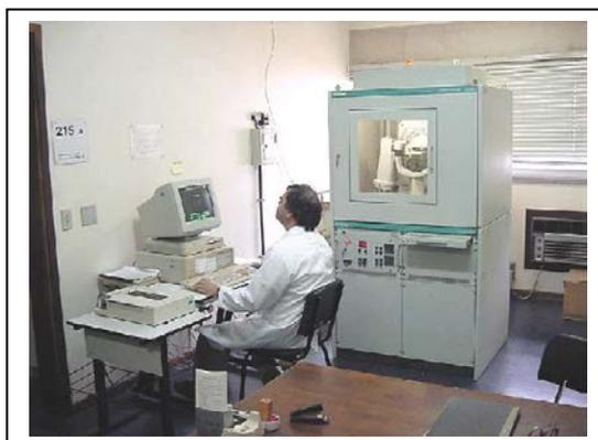
Figura 3 - Difratômetro de marca SIEMENS modelo D5000, do Departamento de Geologia do IGEO/UFRGS.
