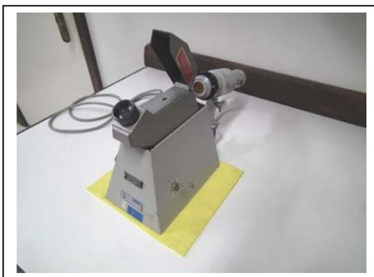
Figura 6 - Refratômetro gemológico de contato marca TOPCON, do Laboratório de Gemologia do IGEO/UFRGS.
