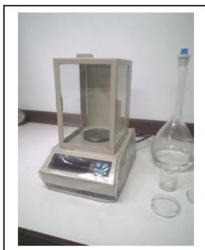
Figura 5 - Balança da marca Marte com capacidade para 200 g e precisão de 0,001g, pertencente ao Laboratório de Gemologia do IGEO/UFRGS.
