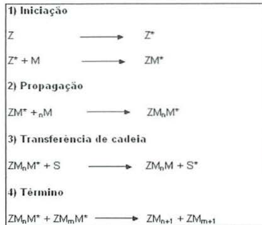
Figura 3 - Esquema simplificado da polimerização em cadeia (2) .
