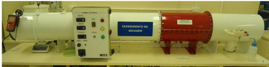
FIGURA 1: Secador de leito fixo com fluxo paralelo de ar.
