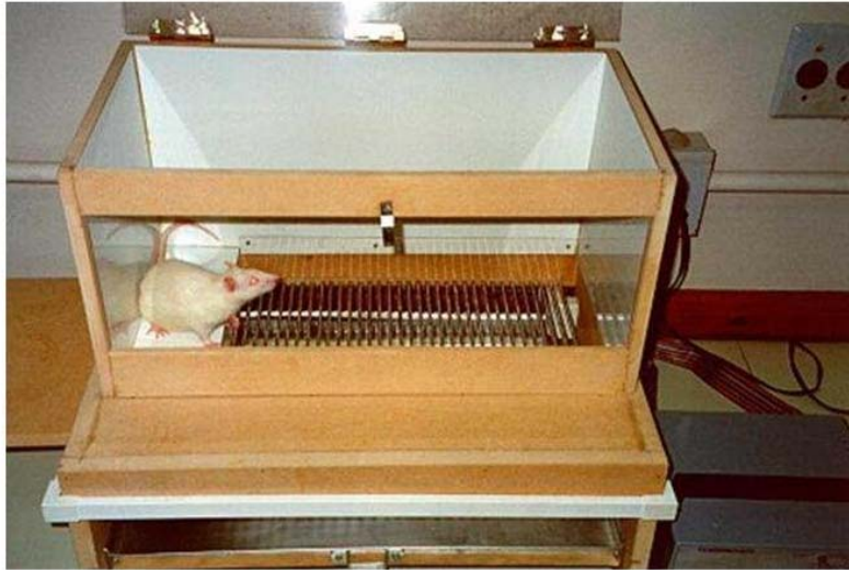
Figura 7 - Vista geral da caixa de condicionamento automatizada (fabricação Albarsch) utilizada no teste comportamental de Esquiva Inibitória.
