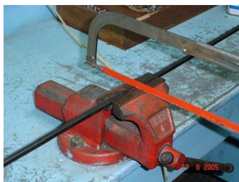
Figura 5.6 – Esquema usado para cortar a barra 3.
