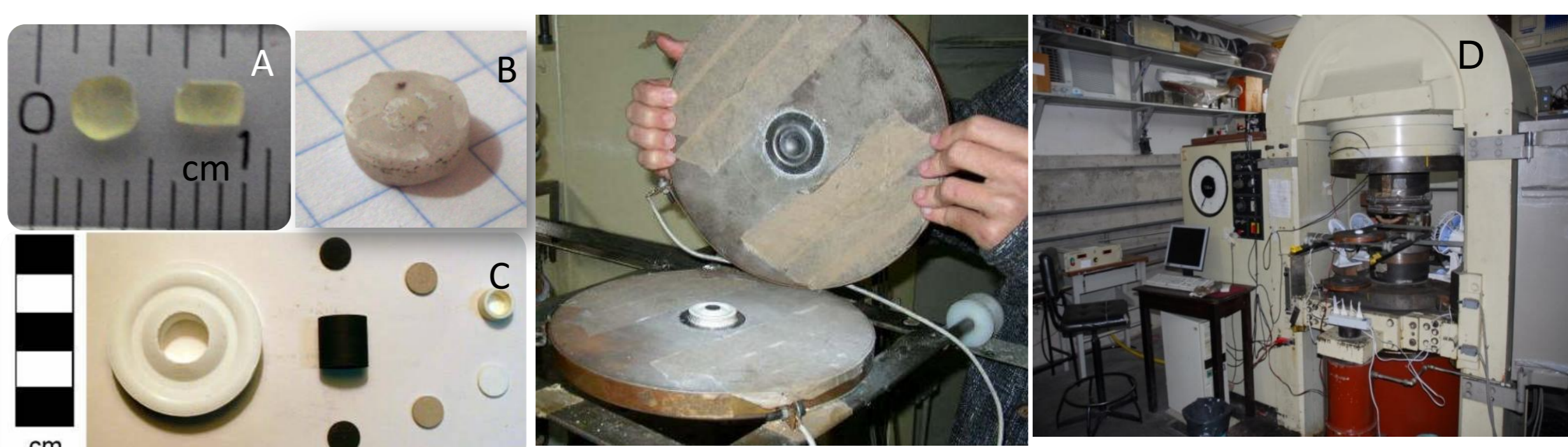
Figura 01: Demonstração dos experimentos com a prensa hidráulica; A) Apatita de Durango; B) Sal com apatita; C) Materiais usados para o experimento; D) Prensa Hidráulica com bigorna toroidal.
