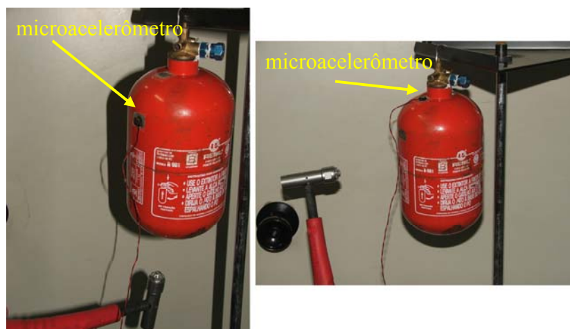
Figura 3.9: Extintor a ser ensaiado (com os microacelerômetros colados por meio de fitas adesivas) e martelo utilizado na solicitação aplicada.
