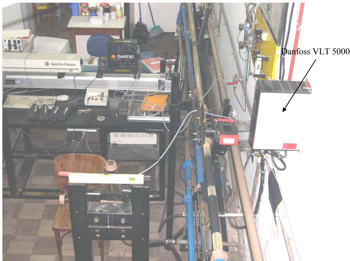
Figura 6.3 – Inversor de frequência Danfoss VLT 5000 utilizado.
