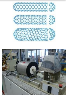
Figura 1: Foto do reator desenvolvido no LACER para a síntese de NTC.
