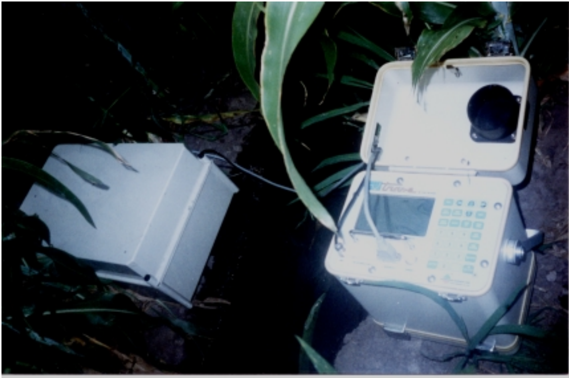
Figura 4.3 - TDR e placa multiplexadora no campo.
