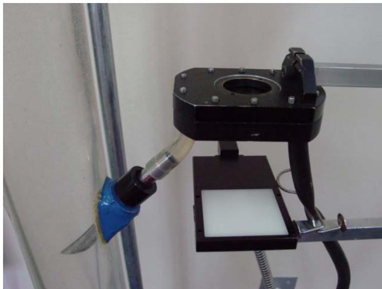
Detalhe do amostrador, visor de bolhas e da placa de fibra ótica ( backlight ) instalado na coluna de flotação.
