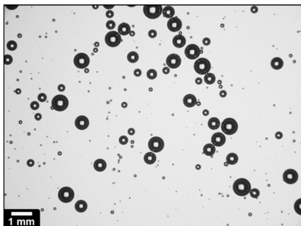
Figura 4.20. Bolhas geradas por venturi (concentração de DF 250 = 10 mg/L, Q_{Ar} = 0,2 L/min, Q_L = 1,2 L/min).
