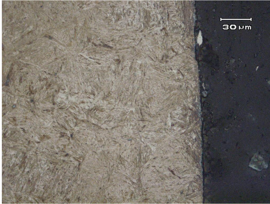
Figura 4.4 – Micrografia em MO da camada cementada em amostra de aço AISI 1020 temperada de forma intensiva.
