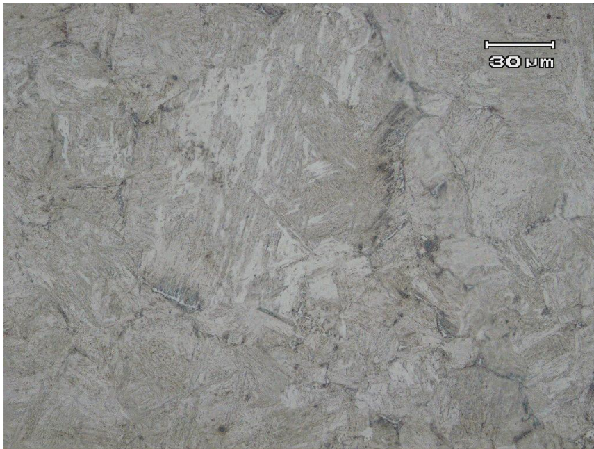
Figura 4.5 – Micrografia em MO do núcleo em amostra de aço AISI 1020 temperada de forma intensiva.
