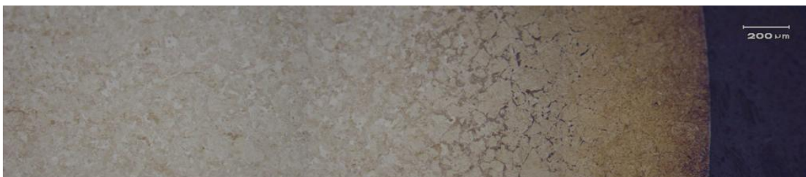
Figura 4.3 – Panorama microestrutural de amostra em aço AISI 1020 cementado e temperado convencionalmente.
