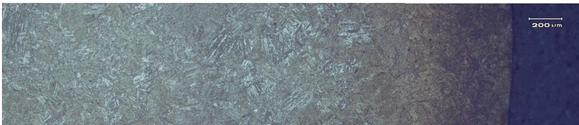
Figura 4.1 – Panorama microestrutural de amostra em aço AISI 1020 cementado e temperado intensivamente.
