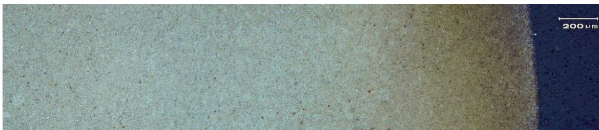
Figura 4.2 – Panorama microestrutural de amostra em aço AISI 8620 cementado e temperado convencionalmente.
