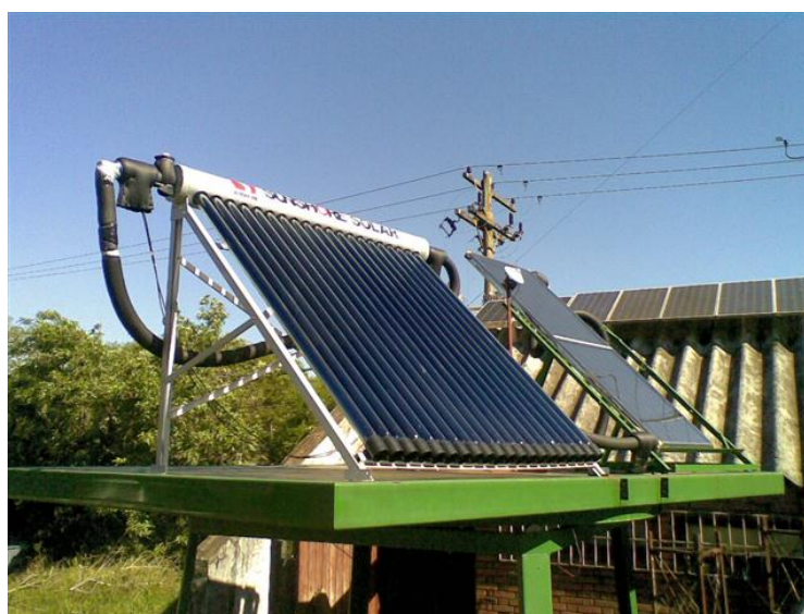
Figura 4.9 – Montagem da bancada com dois coletores solares.
