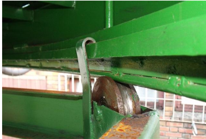
Figura 4.6 - Sistema de segurança do trilho e rodas.
