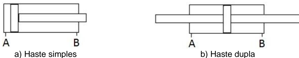
Figura 2.1-Tipos de haste dos cilindros hidráulicos (Pedron,2006).
