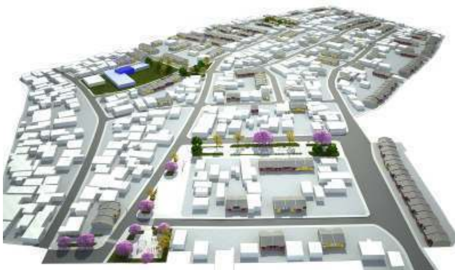
Figura 19: Vila Palmeira e o projeto de intervenção. Os volumes brancos são as edificações existentes a permanecer e os volumes de telhados cinza e bases coloridas são as casas novas a serem executadas.
