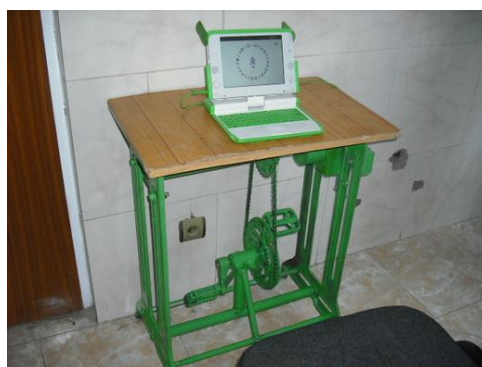
Figura 2 – Computador XO com carregamento mecânico
