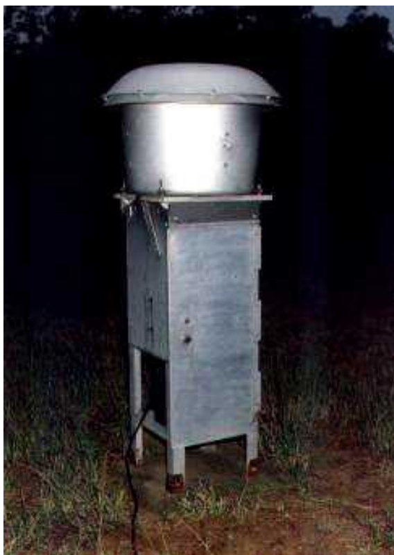
Figura 14 – Equipamento Hi-vol (modelo 305-2000), utilizado para a análise de partículas totais em suspensão - MP.
