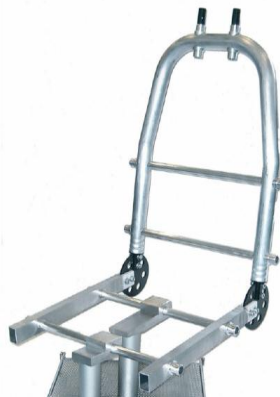
Figura 2.22 - União de materiais dissimilares para estruturas de assentos para ônibus e aviões [Schafer, Pasquale e Kalee, 2009].
