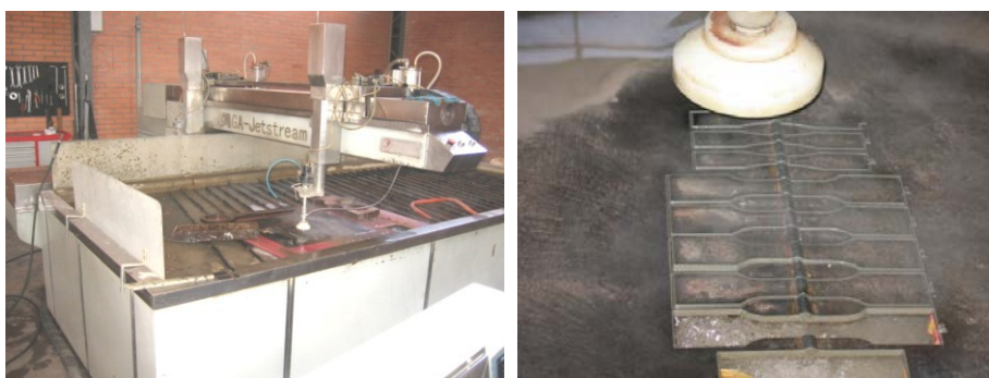
Figura 3.5 HGA – Jetstream . Equipamento de corte a base d'água e os corpos de prova sendo cortados através do processo a jato d'água.
