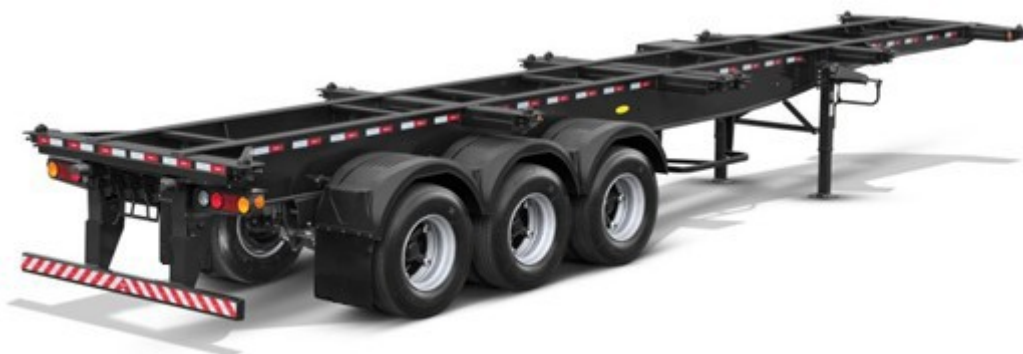
Figura 2.2 Semi-Reboque 3 eixos do tipo Base de Container. Estrutura formada por perfis de aço manufaturados após desbobinamento (RANDON 2010).
