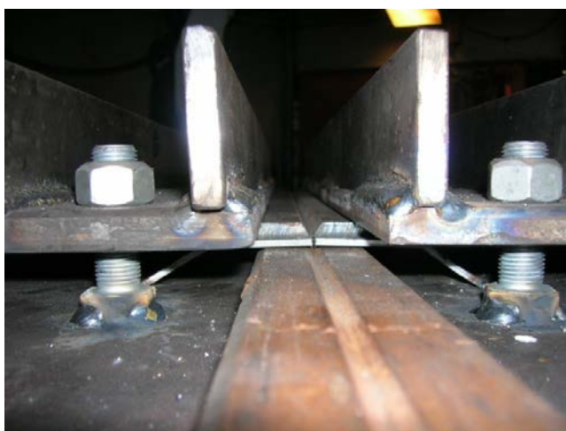
Figura 3.2 Imagem do conjunto montado sobre o cobre junta para realização da soldagem.
