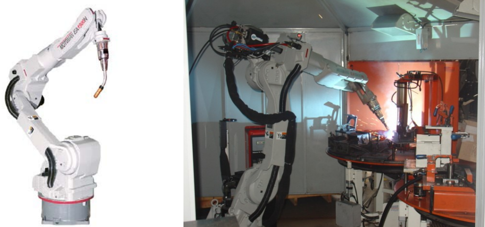
Figura 3.3 Robô Motoman's EA1900N utilizado para a realização da soldagem dos corpos de prova.
