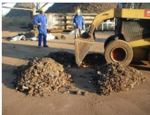
Figura 12: Quarteamento da amostra.
