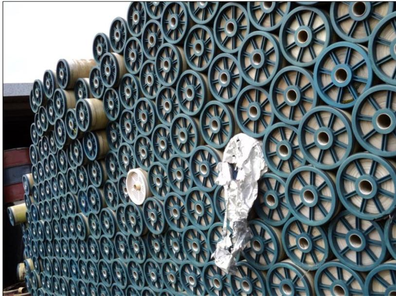
Figura 12: Fotografia da disposição de módulos descartados no pátio da empresa, membranas secas.
