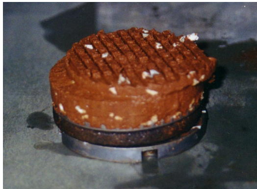
Figura 6.1 – Corpo-de-prova de solo-cimento-poliestireno expandido cisalhado.
