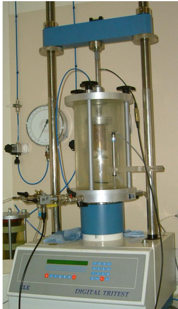
Figura 4.7 – Fotografia do equipamento triaxial durante ensaio.
