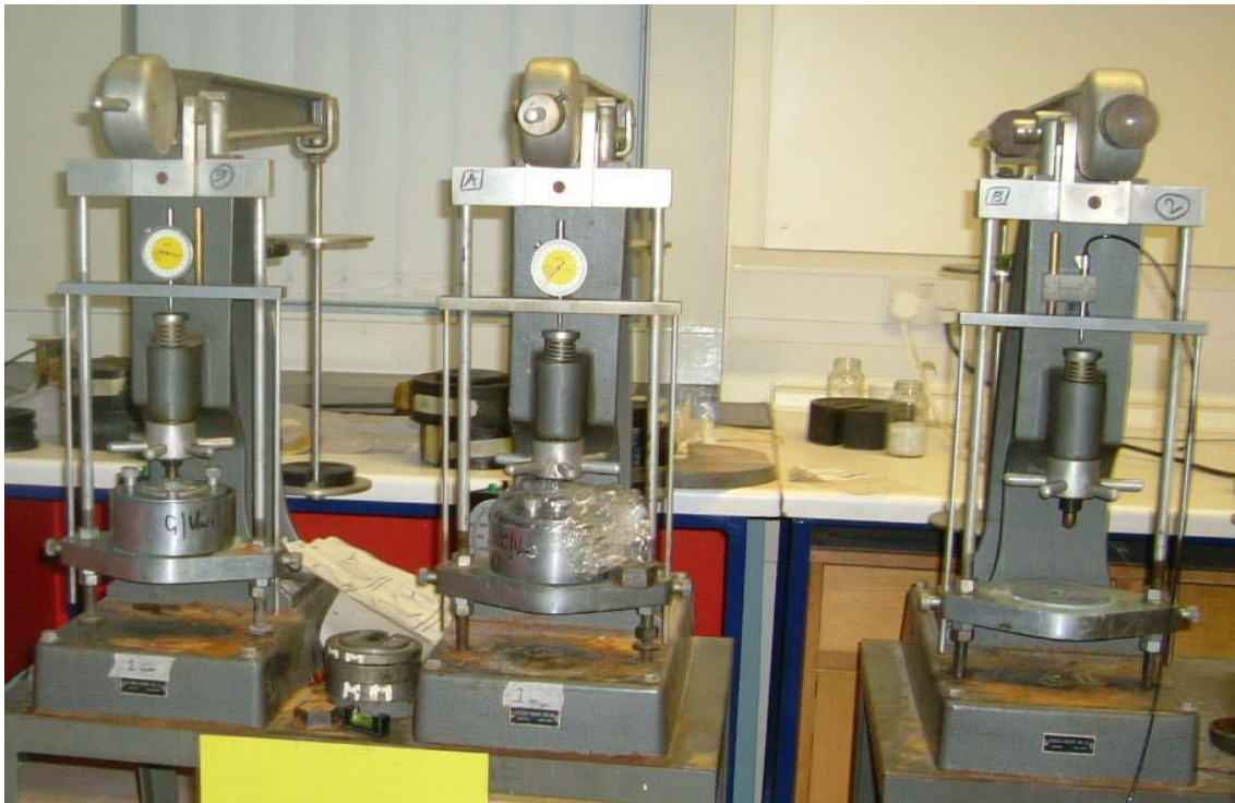
Figura 4.5 – Vista geral dos equipamentos edométricos convencionais da Universidade de Glasgow.
