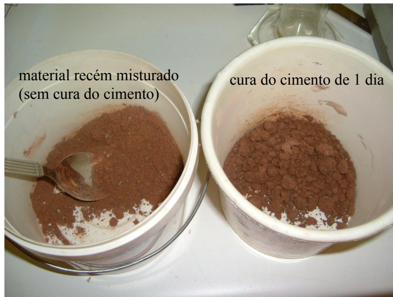
Figura 3.13- Detalhe da estrutura da mistura sem cura (material recém misturado) e com cura de 24horas.
