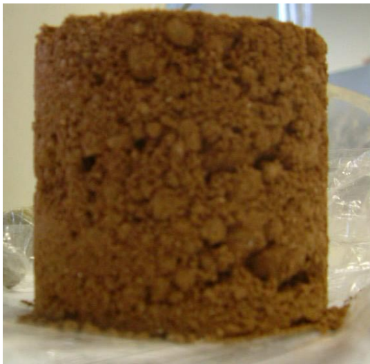
(a) corpo-de-prova para ensaio de compressão isotrópica com controle de sucção
