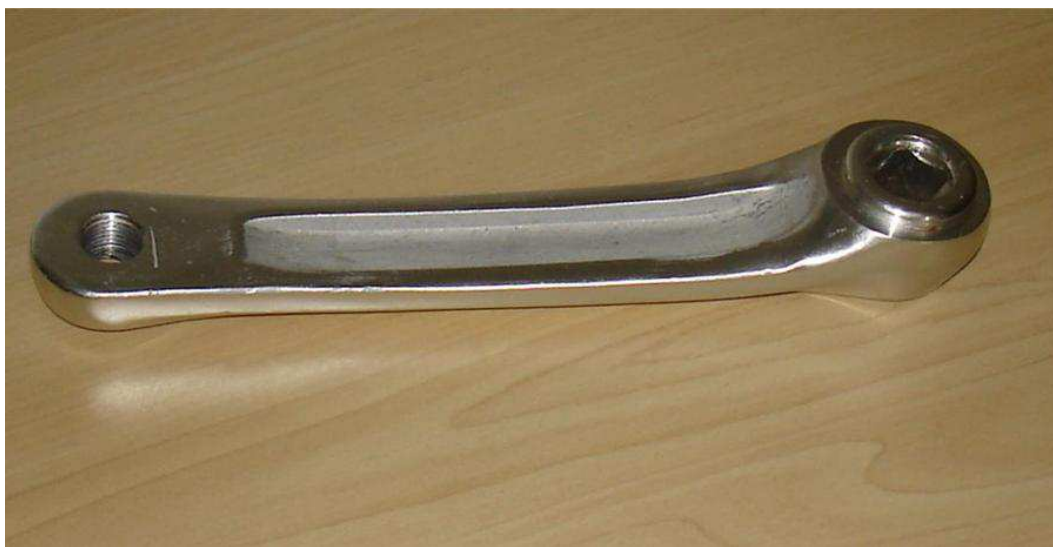
Figura 3.3: Pedivela Dahon 170mm em liga de alumínio AL6061.
