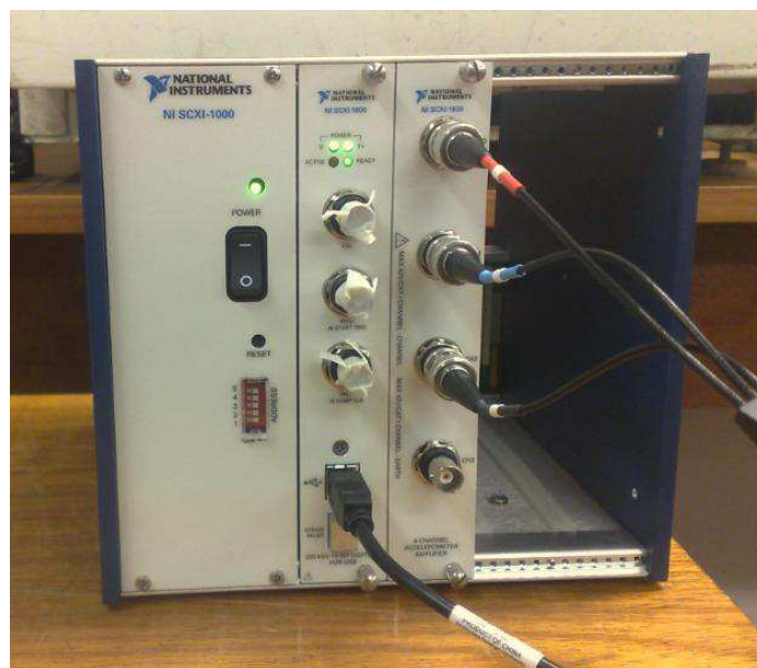
Figura 3.11: Sistema de condicionamento NI SCXI 1530 e de aquisição NI SCXI 1600.
