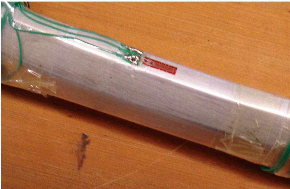
Figura 3.13: Extensômetro cimentado à estrutura.
