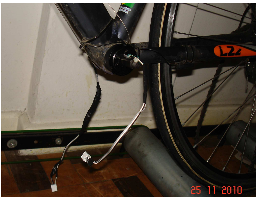
Figura 4.8: Eixo com cabo transmissor acoplado ao movimento central.
