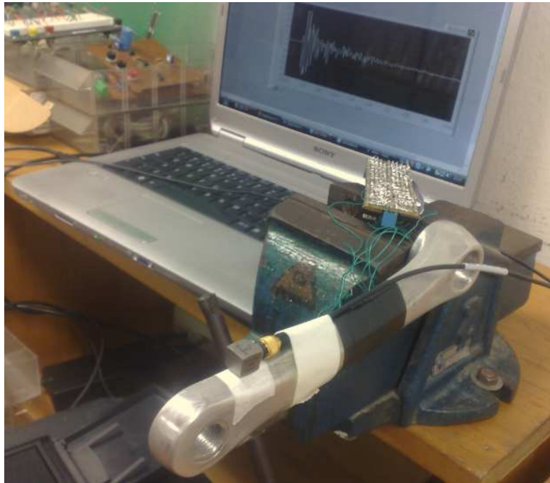
Figura 3.10: Ensaio dinâmico com acelerômetro: pedivela engastado com acelerômetro triaxial Delta Tron 4520.
